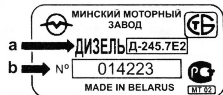
Рис. 1.3. Паспортные данные двигателя Д-245.7Е2
