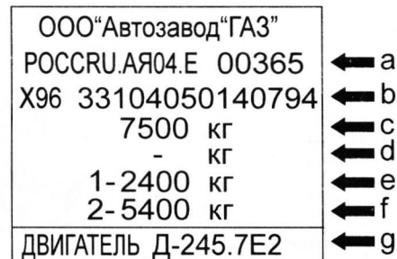
Рис. 1.4. Заводская табличка паспортных данных автомобиля: а – номер одобрения типа транспортного средства; б – идентификационный номер ТС (автомобиля); с – максимально допустимая полная масса автомобиля; д – максимально допустимая полная масса автомобиля с прицепом; е – максимально допустимая нагрузка на переднюю ось; ф – максимально допустимая нагрузка на заднюю ось; g – индекс двигателя
