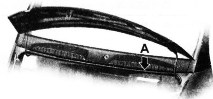
Рис. 1.2. Место нанесения (стрелка А) идентификационного номера кабины
