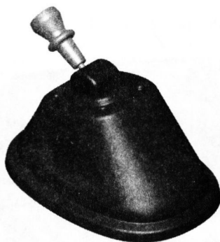
Рис. 1.14. Рукоятка крана стояночного тормоза
