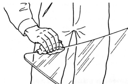
Рис. 9.3. Обезжиривание приклеиваемой поверхности
