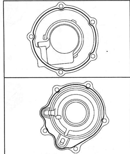
6. Установите фланец, используя специнструмент, затяните контргайку.
