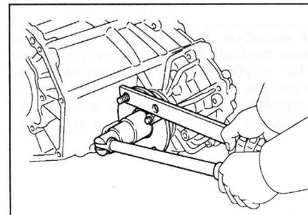
в) Используя съемник, снимите фланец.
