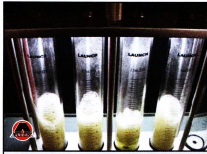
Очевидно, что топливная форсунка в третьем мерном цилиндре подает топлива меньше, чем остальные форсунки.
