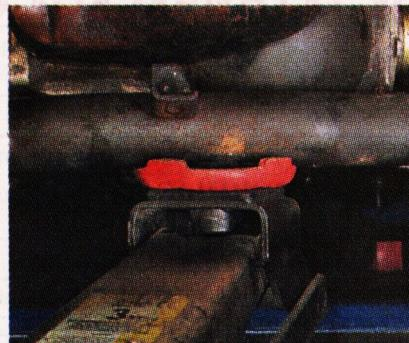
— установить под силовые элементы кузова (задний мост, поперечину, кронштейн или лонжерон) подставку. Вращая ручку штатного домкрата против часовой стрелки (отворачивая клапан подкатного домкрата), опустить автомобиль на подставку.
