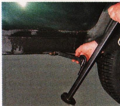
— вращая ручку домкрата, поднять автомобиль (для многих работ достаточно, чтобы колесо лишь оторвалось от опорной поверхности);
