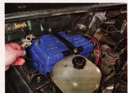
Подсоедините клемму провода к выводу батареи в обратной последовательности.
