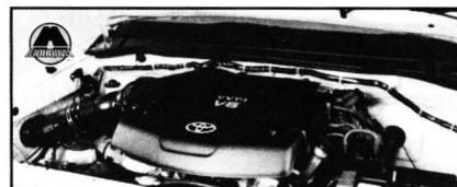
Линейку силовых агрегатов возглавляет трехлитровый турбодизель 1KD-FTV мощностью 171 л.с., комплектуемый как пятиступенчатой механической, так и четырехступенчатой автоматической коробкой передач. Для моделей с данным двигателем производитель обещает расход топлива около 8.3 л на сотню километров пробега.
