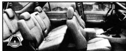
Регулировка сидений механическая, с довольно широким диапазоном настроек. Обзорность с водительского места просто отменная: высокая посадка позволяет видеть дорожную ситуацию на несколько машин вперед; край капота не скрывается из поля зрения, что удобно при парковке, а благодаря большой площади остекления (стекла не тонированные) и зеркалам с крупной рабочей поверхностью, задним ходом маневрировать удобно и безопасно.
