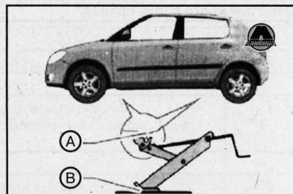
Установите домкрат таким образом, чтобы захват охватывал вертикальную стойку в выемке под порогом (А) и чтобы опорная площадь основания домкрата (В) опиралась всей своей площадью о ровную поверхность основания.
