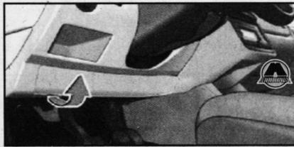
Отдельные цепи тока предохраняются плавкими предохранителями. Предохранители расположены под крышкой в левой боковой стенке панели приборов и под крышкой в подкапотном пространстве слева.
