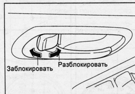
Кнопка блокировки замка двери.
