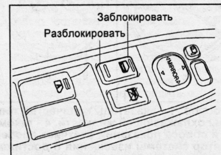
Выключатель центрального замка.
