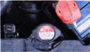
Клапан 1 открывается при увеличении давления в системе до **0,98–1,23 кПа**, и охлаждающая жидкость вытесняется по шлангу 2...
