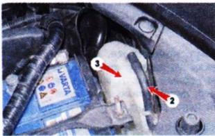
Избыточное давление в системе охлаждения необходимо для повышения температуры кипения охлаждающей жидкости. Эксплуатация автомобиля без крышки радиатора или с крышкой, клапан которой имеет слишком низкое давление срабатывания недопустима! К повреждению элементов системы охлаждения это не приведет, но может стать причиной перегрева двигателя.
