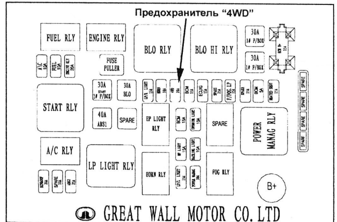
Предохранители и реле блока, расположенного в моторном отсеке.
