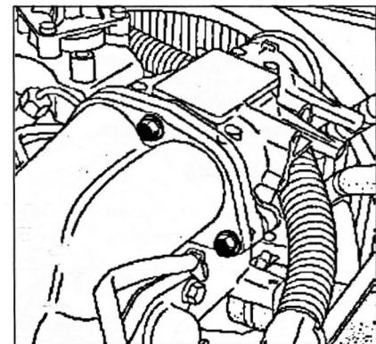
Снимите: шланг с впускного распределительного коллектора, болты крепления впускного коллектора, впускной распределительный коллектор.
