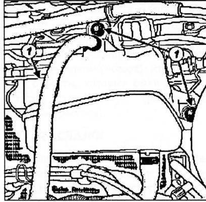
Отверните гайки крепления (1) расширительного бачка. Отведите в сторону расширительный бачок.
