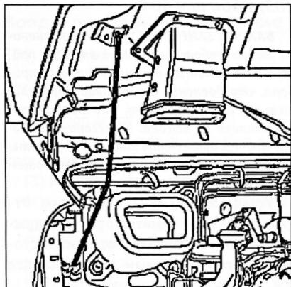
Установите упор капота. Снимите: впускной коллектор, жесткий трубопровод рециркуляции ОГ, блок рециркуляции ОГ, топливопроводы высокого давления форсунок. Отсоедините: колодку проводов к датчику давления в топливораспределительной рампе, разъем электроклапана системы рециркуляции ОГ, колодку проводов к датчику температуры топлива.
