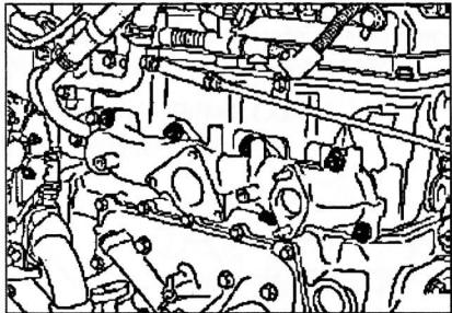
Снимите: гайки шпилек крепления выпускного коллектора, выпускной коллектор.
