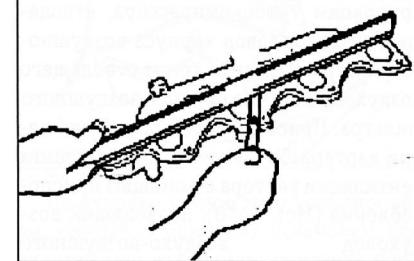
С помощью линейки и набора щупов проверьте плоскость привалочной поверхности. Максимально допустимая неплоскость сопряженной с блоком цилиндров поверхности головки цилиндров: 0,2 мм. Подлежат обязательной замене: шпильки, если они вывернулись при снятии, гайки шпилек крепления выпускного коллектора, прокладка выпускного коллектора. Очистите кругами для матирования поверхности прива-
