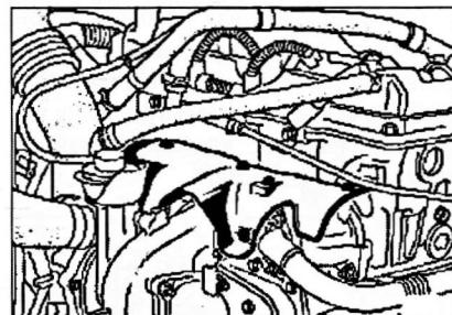
Снимите теплозащитный экран выпускного коллектора.
