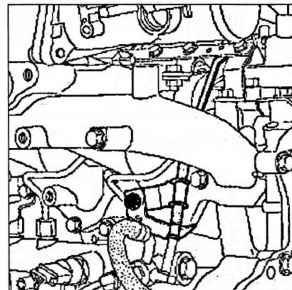
Снимите: болт крепления трубы маслоизмерительного щупа, болт крепления сливной топливной рампы с коллектором. Отсоедините гибкую часть сливной рампы от жесткой части. Снимите гибкую часть сливной рампы.
