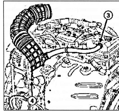
Разведите хомут (3) шланга вентиляции картера с помощью приспособления (Mot. 1448). Отсоедините шланг вентиляции картера. Распустите хомут крепления (4) отводящего воздухопровода на корпусе воздушного фильтра. Снимите: отводящий воздухопровод корпуса воздушного фильтра, маслопроводы
