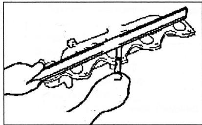
С помощью поверочной линейки и набора щупов проверьте отсутствие деформации привалочной поверхности. Максимально допустимая неплоскость: не более 0,2 мм. Очистите и обезжирьте привалочные поверхности: выпускного коллектора в случае его повторного использования, ГБЦ, жесткого трубопровода рециркуляции ОГ.
