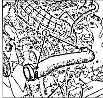
Ослабьте затяжку хомутов (2) крепления подводящего воздухопровода воздухо-воздушного охладителя. Снимите подводящий воздухопровод воздухо-воздушного охладителя.
