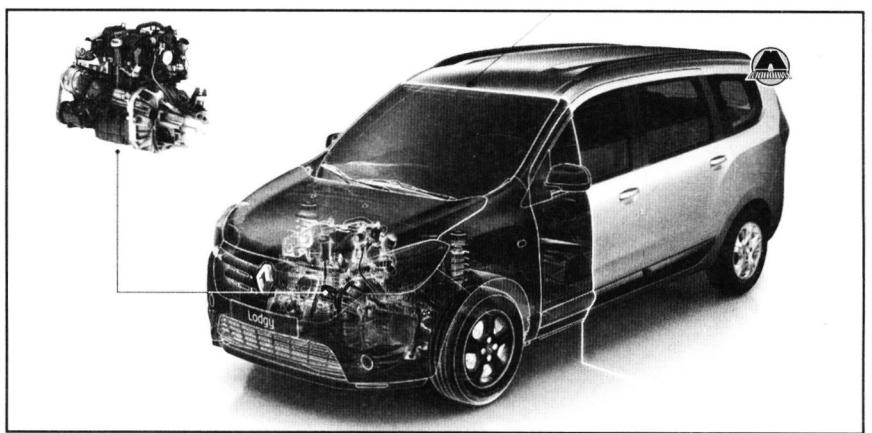
Гамма двигателей Renault (Dacia) Lodgy представлена бензиновыми двигателями объемом 1,2 л и 1,6 л и мощностью соответственно 73 л. с. и 82 л. с., а также турбодизелями объемом 1,5 л, в зависимости от степени форсировки развивающими 75 л. с. или 90 л. с. Все двигатели комплектуются только механическими пятиступенчатыми коробками передач.
