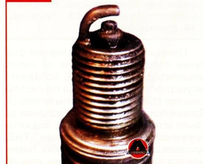
Свеча зажигания, показанная на фото №6, вывернута из неработающего цилиндра. Центральный электрод такой свечи, а также его юбка покрыты плотным слоем масла с каплями не-
