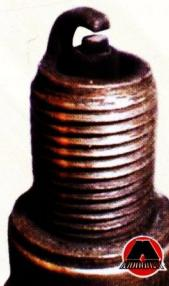
Свеча, изображенная на фото №2, вывернута из двигателя с повышенным расходом топлива. Центральный электрод такой свечи покрыт бархатисто-черным нагаром. Причинами этого могут быть богатая воздушно-топливная смесь (неправильная регулировка карбюратора или неисправность системы электронного впрыска), засорение воздушного фильтра.
