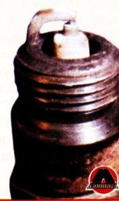
Свеча зажигания, изображенная на фото №3, вывернута из неработающего цилиндра. Центральный электрод такой свечи, а также его юбка покрыты плотным слоем масла с каплями не-
