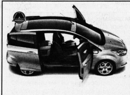
Главной особенностью новинки стала технология Easy Access Door System: задние двери со сдвижным механизмом и отсутствие средней стойки в привычном ее понимании. При открытии обеих боковых дверей
