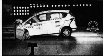
Безопасности водителя и пассажиров в Ford B-Max уделено большое внимание. Полный комплект подушек безопасности (фронтальные, боковые, коленная для водителя и шторки безопасности) входит в базовое оснащение автомобиля. По результатам серии краш-тестов, проведенных независимой организацией EURO-NCAP в 2012 году, автомобиль получил высший рейтинг безопасности — пять звезд.
