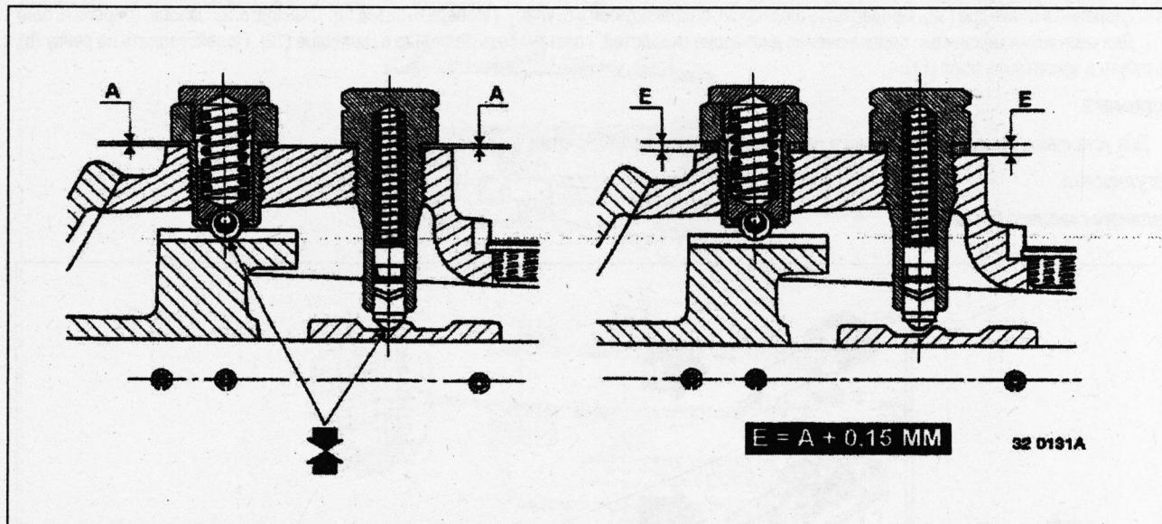
Завинтить задвижку до такой степени, чтобы шарик был в контакте с приводной деталью. Измерить величину "А". Определить толщину "Е" регулировочных прокладок. Поставить регулировочные прокладки на место. Сократить как можно больше их число. Поставить задвижку на место. Затянуть рекомендованным моментом.
