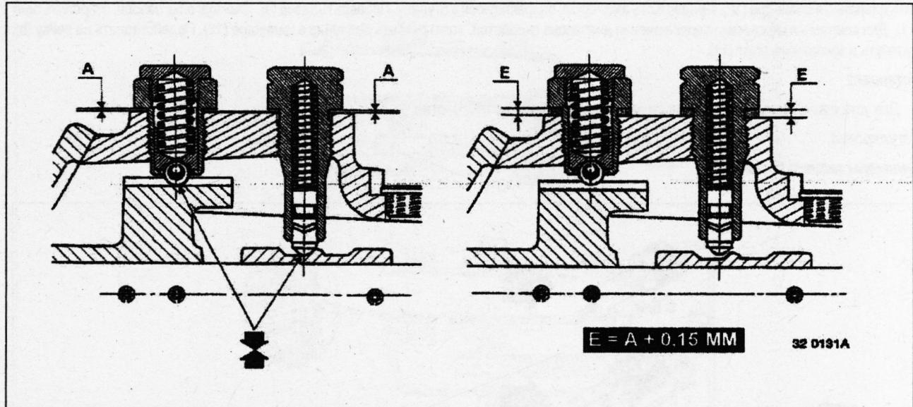
Завинтить задвижку до такой степени, чтобы шарик был в контакте с приводной деталью. Измерить величину "A". Определить толщину "E" регулировочных прокладок. Поставить регулировочные прокладки на место. Сократить как можно больше их число. Поставить задвижку на место. Затянуть рекомендованным моментом.
