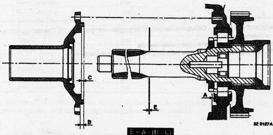
Обеспечить отступ (R). R = 1 мм. Измерить величины "A/B/C". Определить толщину "E" регулировочных прокладок (21). Сократить как можно больше число вставляемых прокладок.
