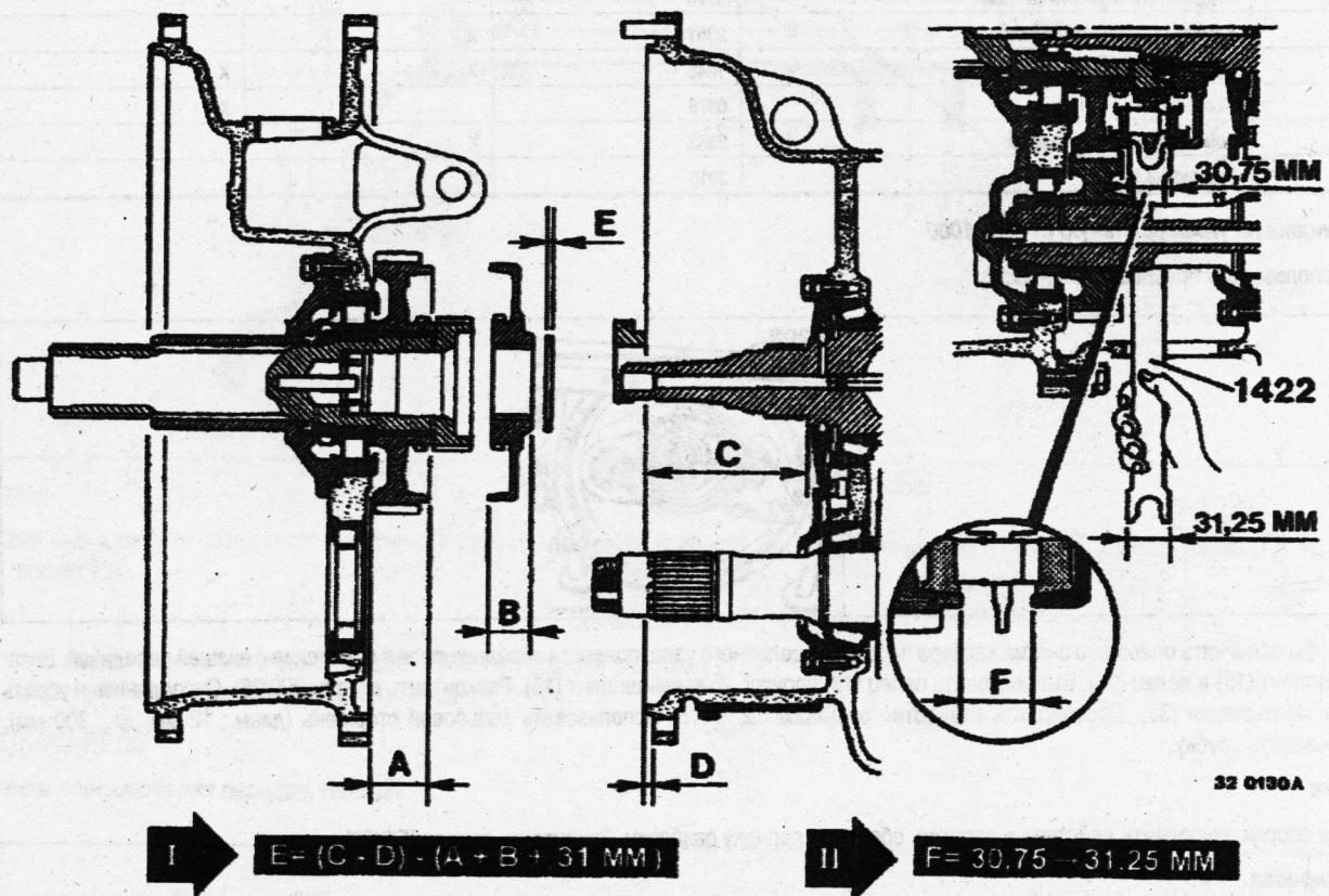
Измерить величины "А/В/С/Д".  $F = 31 \pm 0,25 \text{ мм}$ . Определить толщину "Е" регулировочной прокладки (11). При необходимости, пришлифовать. Установить картер на релейный узел (2).
