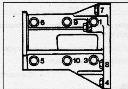
Установить суппорт приемного блока сцепления. Затянуть болты рекомендован-
