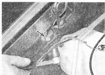
Рис. 9.3. Снимите болт (указан стрелкой), крепящий кабель заземления в двигательном отделении.
