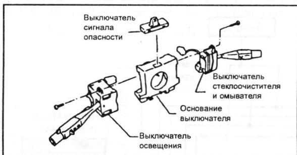
Выключатель освещения и выключатель стеклоочистителя и омывателя могут быть заменены без снятия основания комбинированного выключателя.
