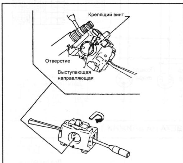
Чтобы снять основание комбинированного выключателя, вывинтите винт, крепящий основание, и поверните основание, надавливая на него.
