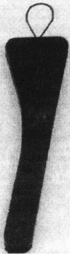
Рисунок 14.7 Перед снятием звездочки распределвала поместите инструмент для удерживания натягивателя между цепью, рядом с натягивателем — проследите за тем, чтобы инструмент имеет петельку из проволоки, закрепленную на его конце, так, что его можно будет с легкостью удалить по окончании работы — если Вы не располагаете таким инструментом, можно использовать деревянный брусок с проволокой на конце
