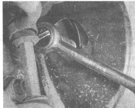
21.4 Откручивание фиксирующего болта узла передней ступицы/диска
