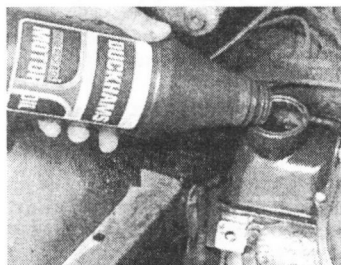
Фото 5. Доливание моторного масла в двигатель. Количество масла, необходимое для поднятия уровня масла от минимальной метки на измерительном штырьке до максимальной метки, равно одному литру
