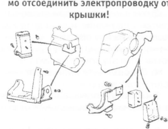
Рисунок 1.5. Детали задних креплений двигателя (Раздел 6)
