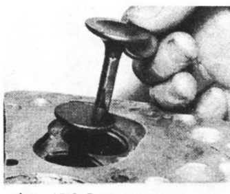
Фото 45.2. Вставьте клапан в их соответствующие направляющие
